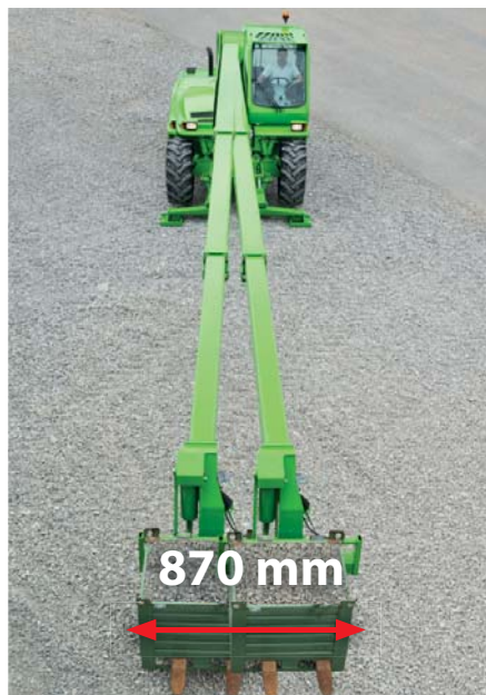
Traslazione laterale del braccio
