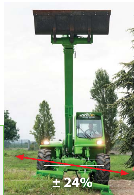
L'azione combinata dell'inclinazione laterale e degli stabilizzatori
