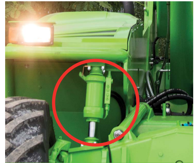
Sistema Tilting per la correzione dell'inclinazione
